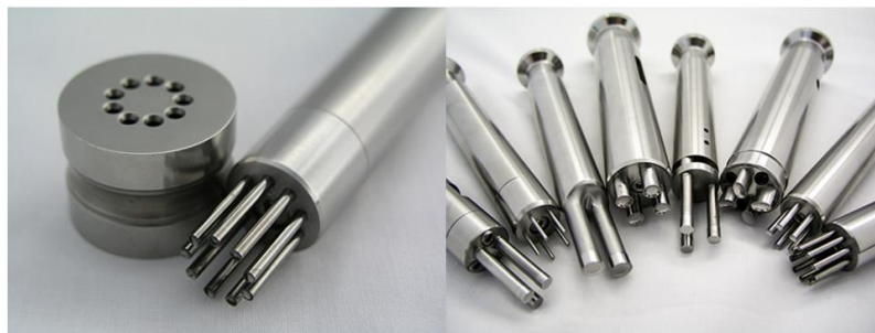
Gambar 2.8 Alat tablet mini: kombinasi punch dan die (kiri); desain yang berbeda pada multitip tablet mini, seperti beberapa bagian desain cap-and-pin dan desain multitip yang solid (kanan) (Tumuluri, 2015)
