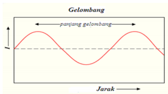
Gambar II.3. Radiasi Elektromagnetik dengan panjang gelombang \lambda (Underwood & R.A.Day, 1986)
