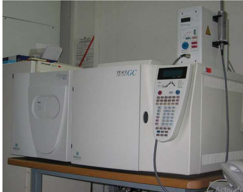
Gambar 2. 2 Instrumen Kromatografi Gas-Spektrofotometri Massa (Gohlke & Mclafferty, 1996)
