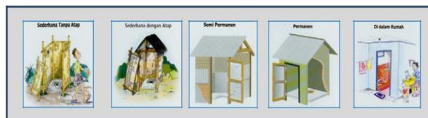
Gambar 2.1 Bangunan Atas Jamban
