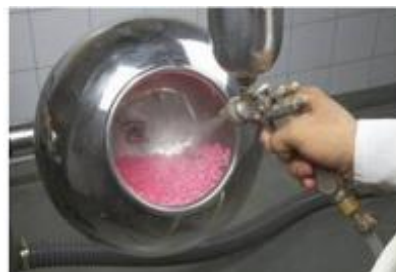
Gambar 2. 6 Proses penyalutan menggunakan conventional coating pans
