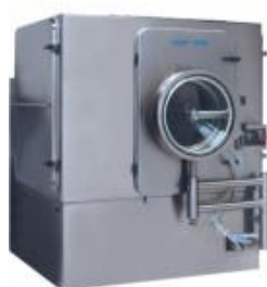
Gambar 2. 7 Proses penyalutan menggunakan perforated coating pans
