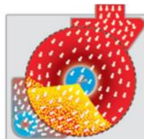
Gambar 2. 7 Proses penyalutan menggunakan perforated coating pans
