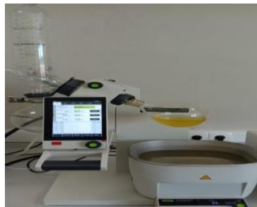
Gambar 3. Proses Pemekatan dengan Menggunakan Rotary Evaporator dan Oven
