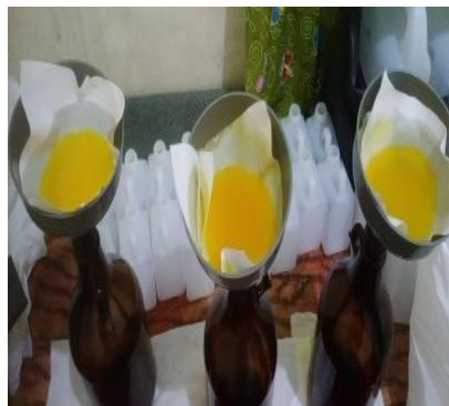
Gambar 2. Proses Ekstraksi dengan Metode Maserasi
