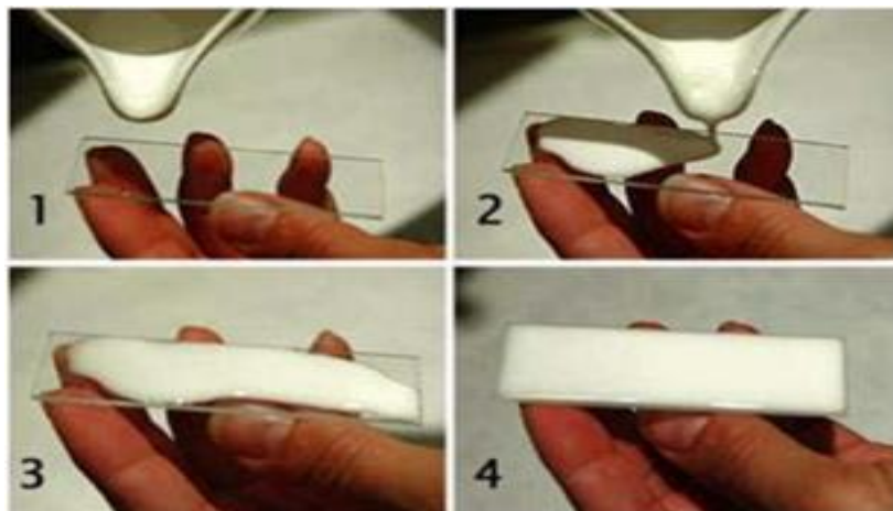
Gambar II.5. Langkah preparasi pelat KLT (Kumar et al., 2013)
