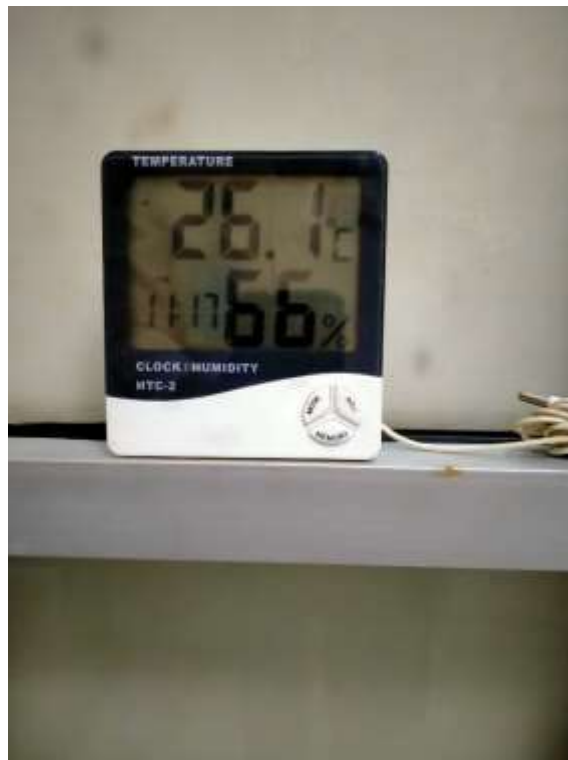
Gambar 5. 20 Alat Pemantau Suhu Ruangan
