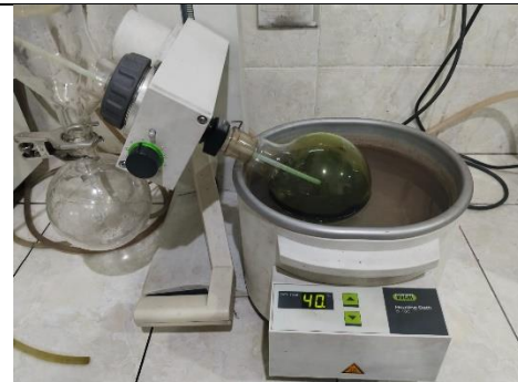
Pemekatan ekstrak menggunakan Rotary evaporator
