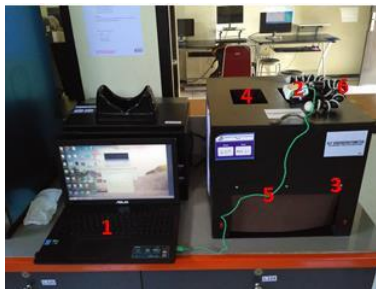
Gambar VI.2 : Rangkaian peralatan KLT video densitometri. (1) Software Image J, (2)Kamera, (3) Kotak lampu UV, (4) UV filter, (5) kabel USB dan (6) gorila pod.
