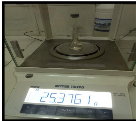
Gambar 2.1. Bobot Jenis Water Kefir ditentukan dengan piknometer
