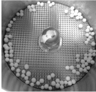
Gambar II.6 Pelet dalam alat sferoniser (Bryan, 2015)
