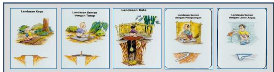
Gambar 2 3 Bangunan Tengah Jamban
