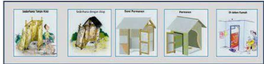
Gambar 2 2 Bangunan Atas Jamban
