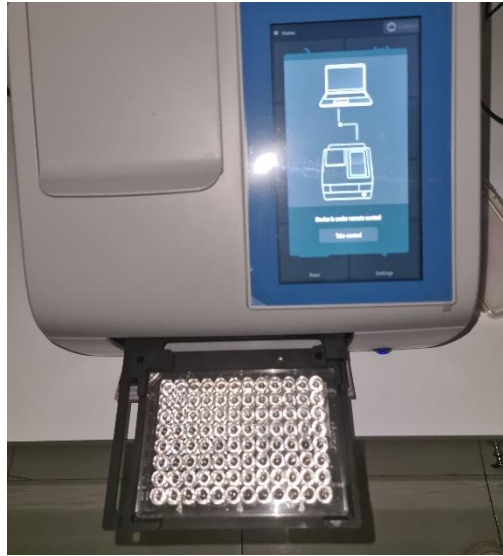
Pengecekan Absorban menggunakan mikroplate Reader
