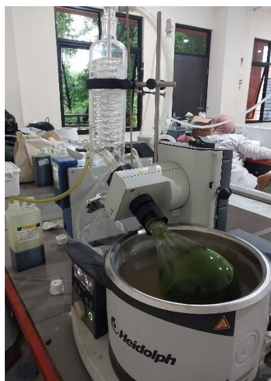
(Pemekatan ekstrak menggunakan rotary evaporator)
