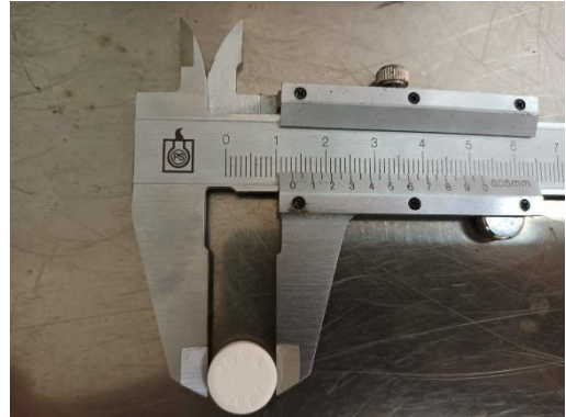
Pengukuran uji keseragaman ukuran dengan menggunakan jangka sorong
