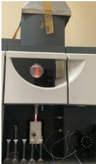
Gambar 7. Kerang Hijau didestruksi, dianalisa menggunakan ICP-OES
