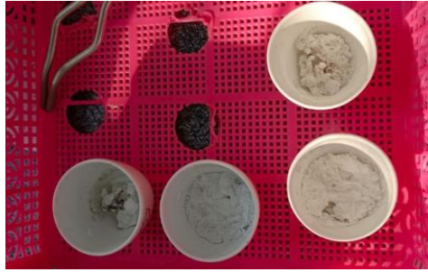
Gambar 5. Setelah dikeluarkan dari Tanur, didinginkan
