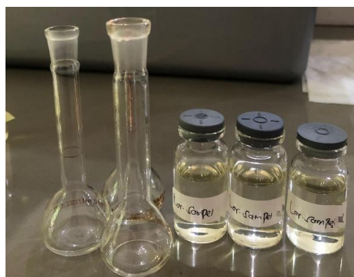
Larutan sampel pengenceran ke labu takar 10 mL
