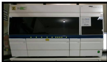
Alat Cobas Integra tipe 400 plus untuk mengukur kadar trigliserida dan kolesterol HDL
